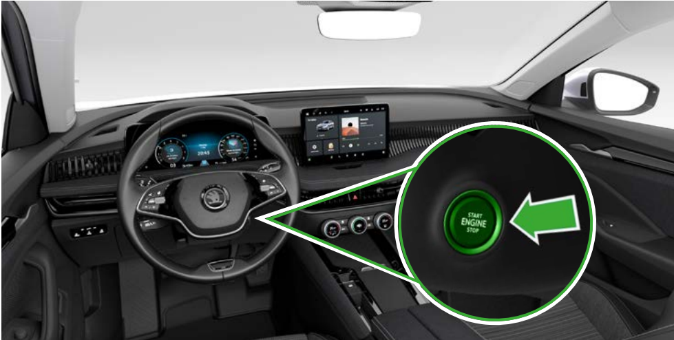
Pulsante "START-ENGINE-STOP" sulla colonna dello sterzo
