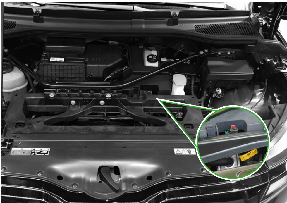
Collegamento di emergenza nella parte anteriore dei veicoli elettrici, vedere anche Nuova identificazione per i modelli prodotti dopo il 2023
