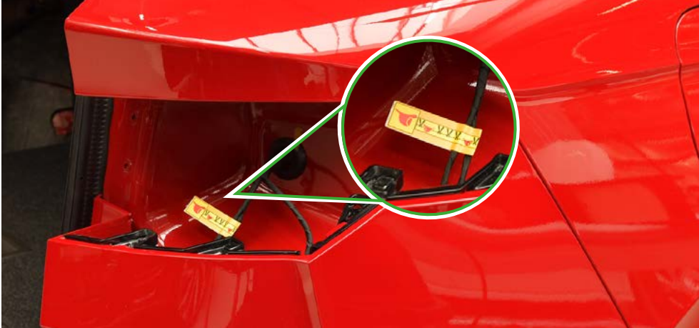
Collegamento di emergenza sotto la luce posteriore, vedere anche Nuova identificazione per i modelli prodotti dopo il 2023
