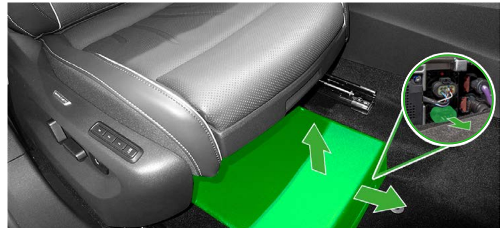
Disconnessione del sistema da 48 V in una Superb dal 2023 in poi
