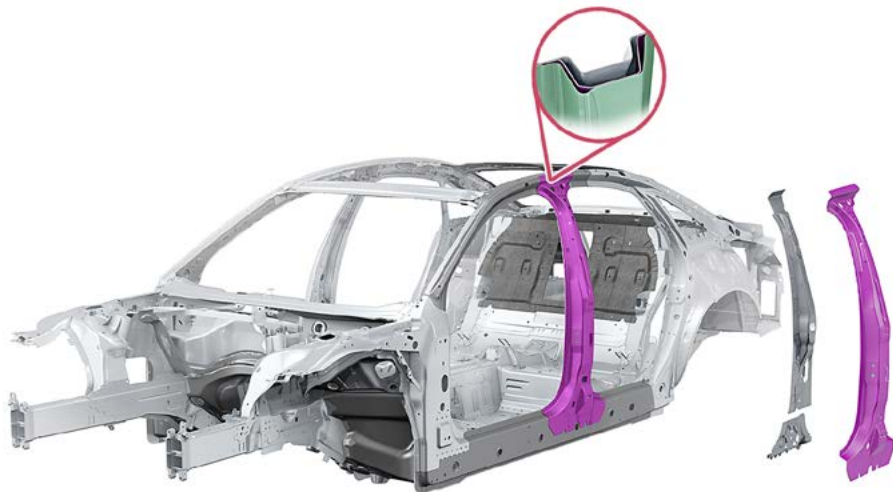
Montante B con struttura a guscio multiplo
