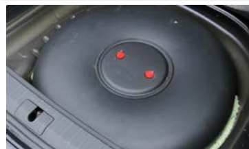
Serbatoio GPL nel pavimento del bagagliaio
