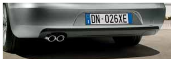
Diffusore posteriore (FAA 800 002) Terminale di scarico per 1.4 TSI (FDC 610 001); per 1.9 TDI (FDC 620 001)
